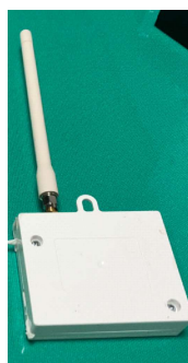
受信機 電源：USB電源 腕に装着し青葉山に移動しながら受信
